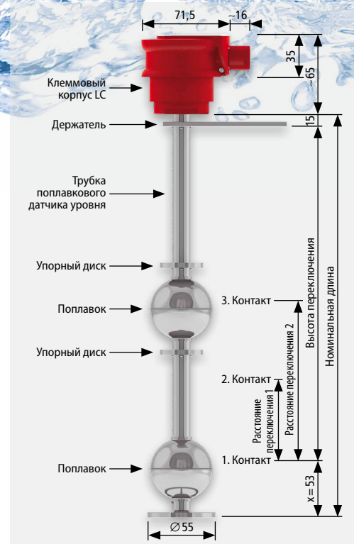
Поплавковый датчик уровня из нержавеющей стали с 3 контактами, версия LC
